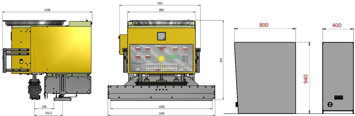
**NB: Die graue Box ist der Maschinentransformator**
